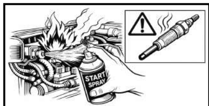
Рис. 2-7. Опасность применения вспомогательной пусковой жидкости при наличии системы предпускового подогрева
