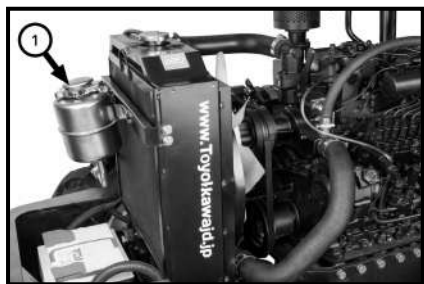
Рис. 5-5. Проверка уровня рабочей жидкости в системе рулевого управления
