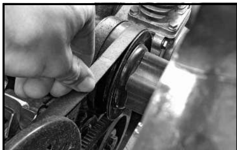
Рис. 5-17. Проверка и регулировка натяжения ремня
