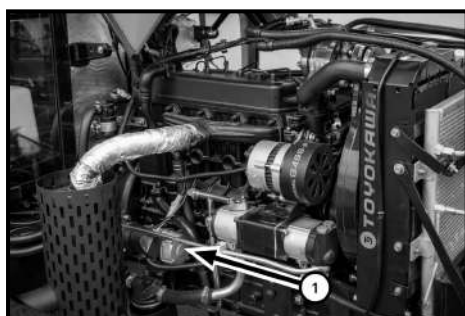
Рис. 5-22. Стартерный двигатель 1 – стартерный двигатель
