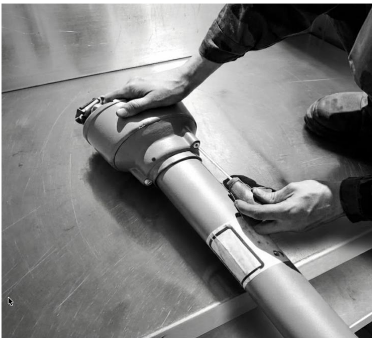
Рис. 8 Демонтаж защитного кожуха.
