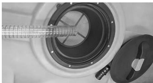
Заправка емкости водой через патрубок с помощью штатного насоса (опционально).
