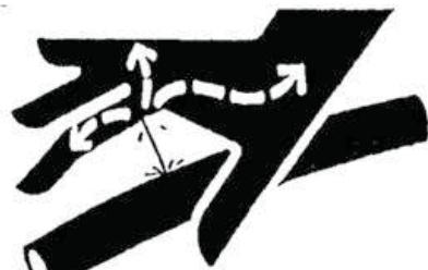
**Рис. 1.9 Утечка из гидравлического трубопровода**
