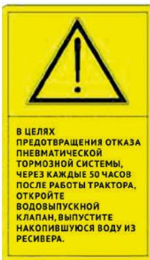
**Рис. 1.30 Предупреждающий знак пневматического тормоза**
