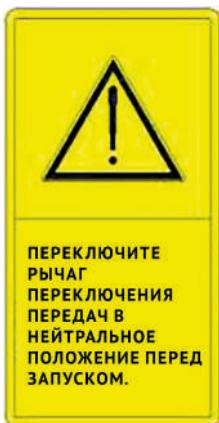
**Рис. 1.31 Предупреждающий знак безопасности при запуске**
