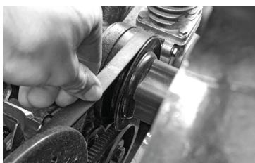
Рис. 5.21 Регулирование натяжения приводного ремня вентилятора
