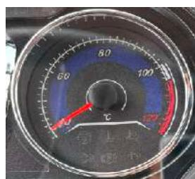
**Рис. 3.4 Указатель температуры воды**
