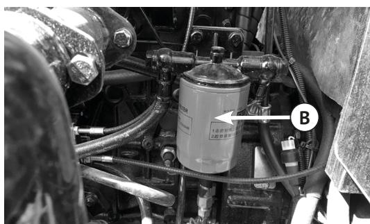
**Рис. 5.32 Топливный фильтр**
