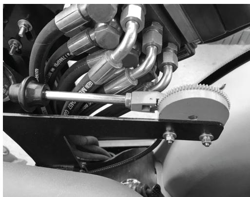
Рис. 3.16 Ручной акселератор
