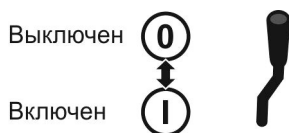
Рисунок 3.12. Схема управления ВОМ
