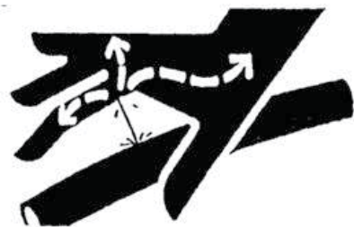
Рис. 1.9 Утечка из гидравлического трубопровода
