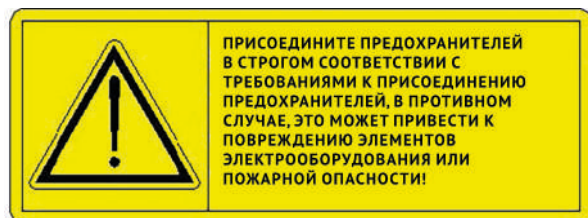
Рис. 1.27 Предупреждающий знак безопасности предохранителя
