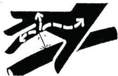
Рис. 1.9 Утечка из гидравлического трубопровода
