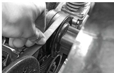
Рис. 5.21 Регулирование натяжения приводного ремня вентилятора
