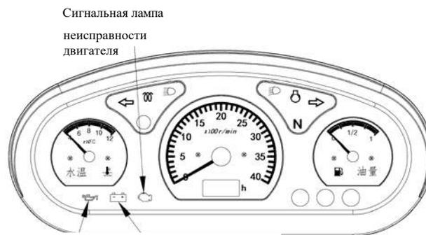
Индикатор мотормасла Предупреждение о напряжении аккумулятора
