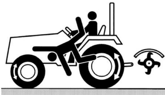
2. Во время буксировки используйте **буксировочный крюк** и никогда не вешайте прицеп на кронштейн или ось трехточечной навески. В противном случае трактор может быть поврежден или перевернут.
