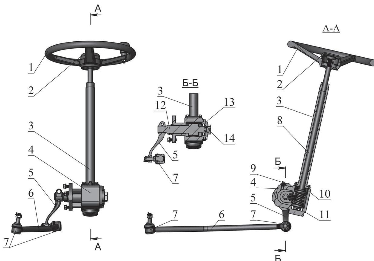
Рис. 19. Рулевой механизм
