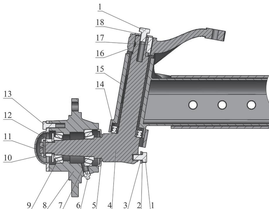
**Рис. 17. Регулировка зазоров колеи конических роликовых подшипников**
