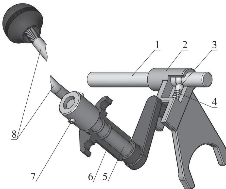
**Рис. 9. Устройство механизма переключения повышенных/пониженных передач**
