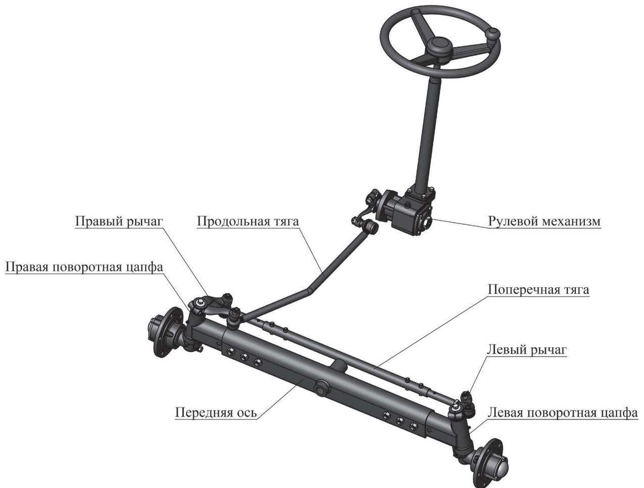
**Рис. 20. Рулевой привод**
