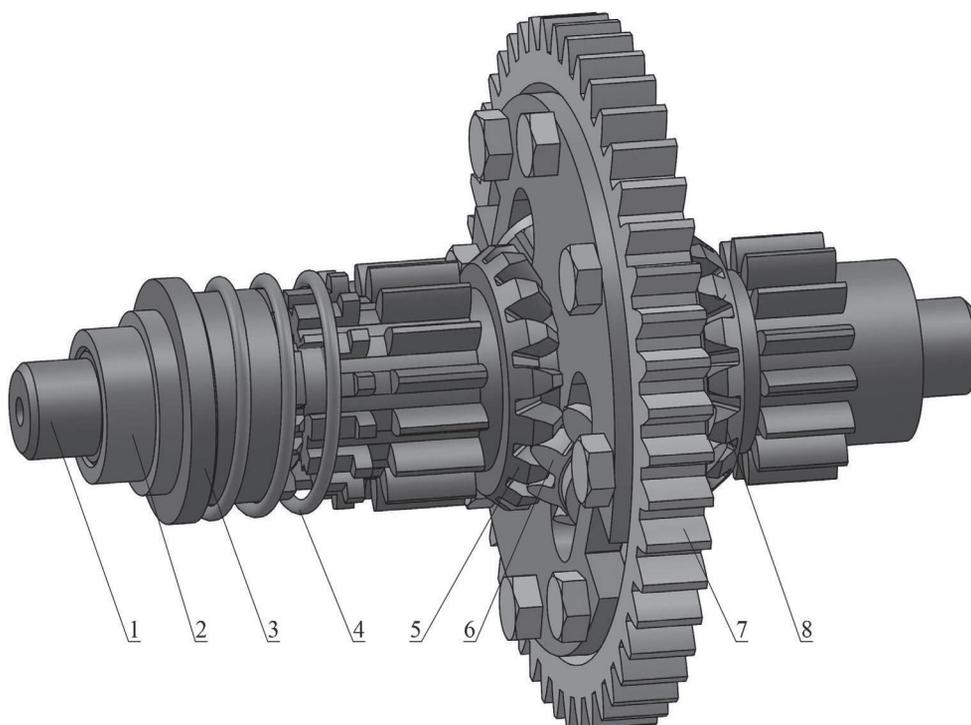
**Рис. 5. Устройство дифференциала**
