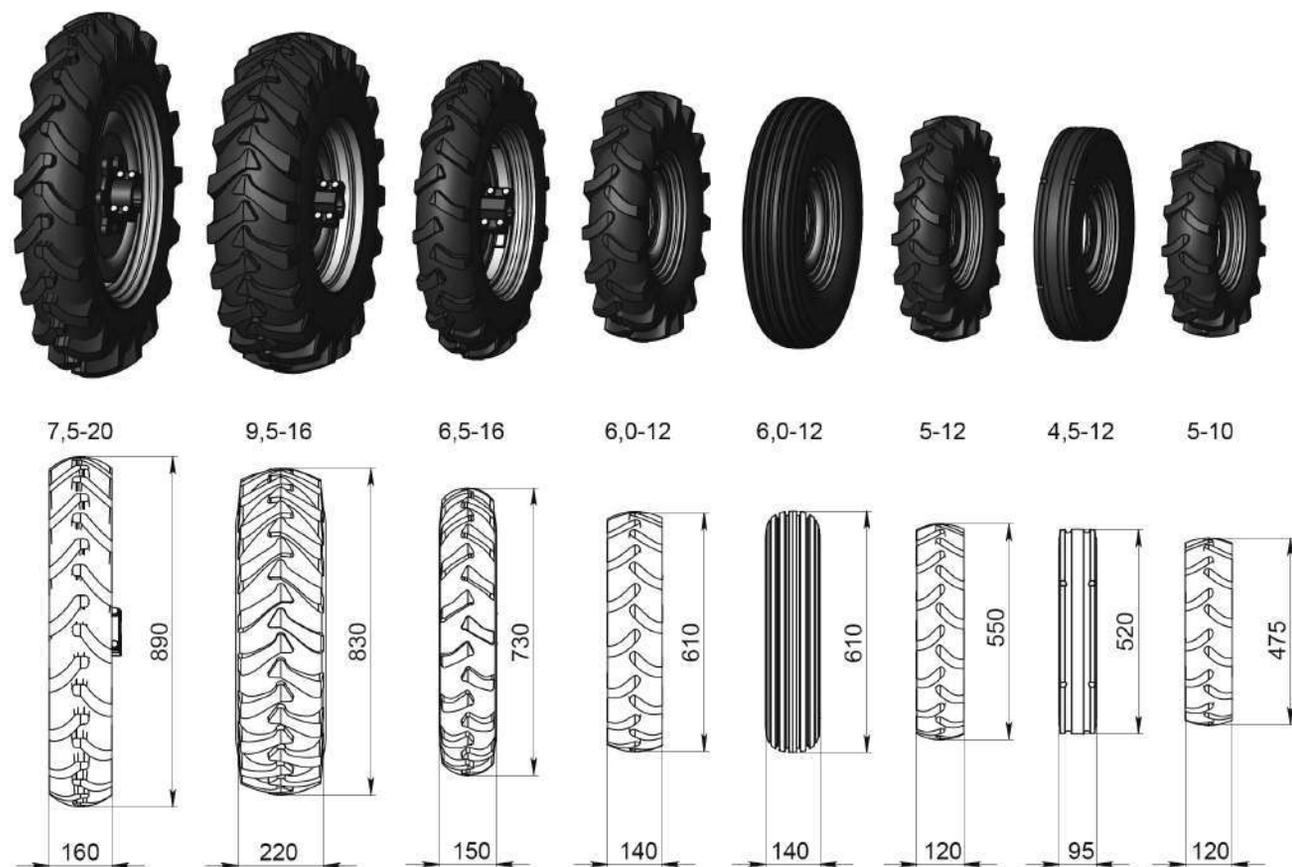
Рис. 18. Размеры колес
