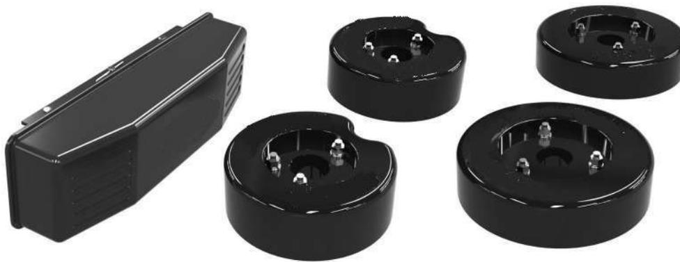
При использовании комплекта балластов, КПД трактора возрастает на 14%, а крюковая мощность увеличивается на 48%.
