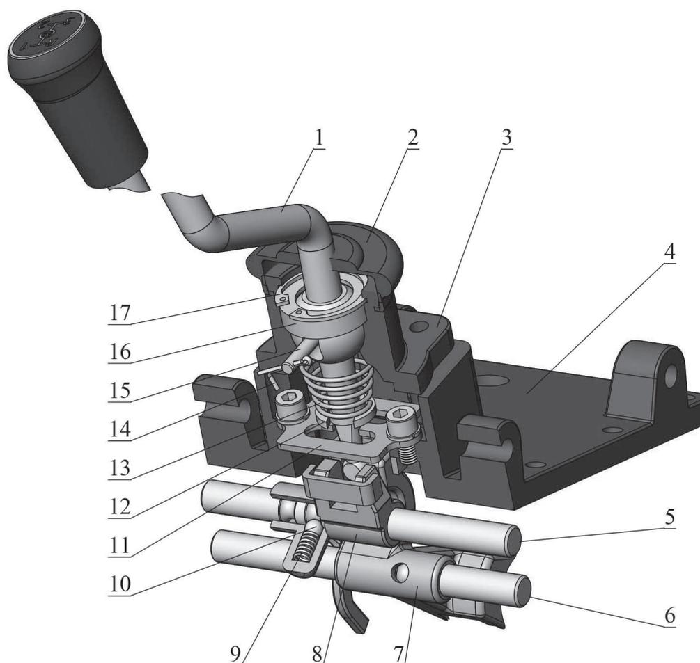
**Рис. 8. Устройство механизма переключения передач 1, 2, 3, R**
